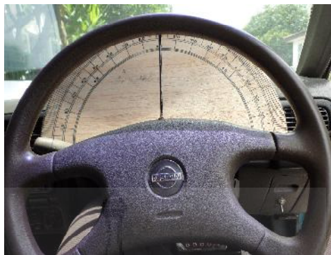
รูปที่ 3.12 การติดตั้งเครื่องมือวัดมุมพวงมาลัย
