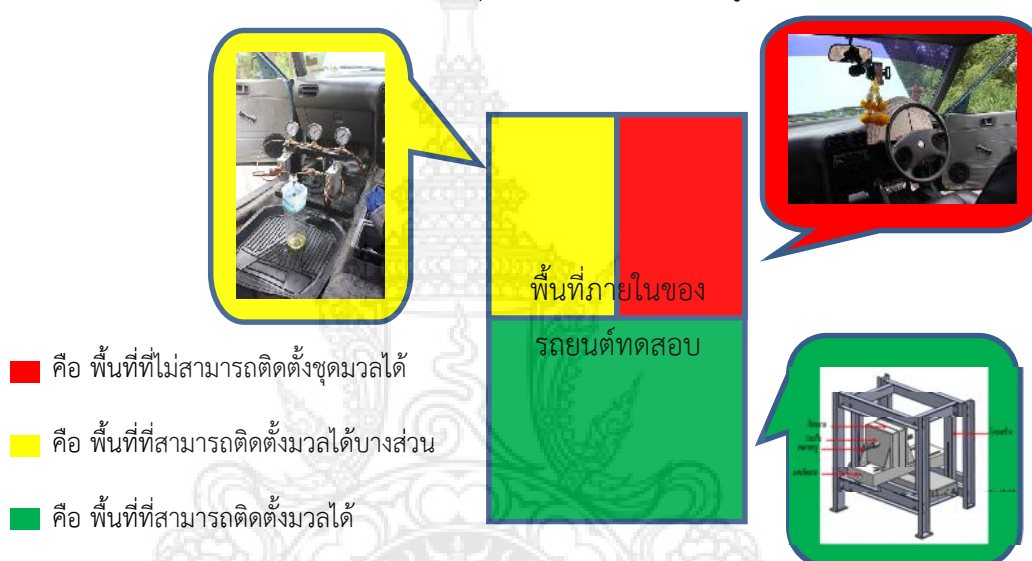
รูปที่ 3.9 บริเวณติดตั้งชุดกระจายมวล
