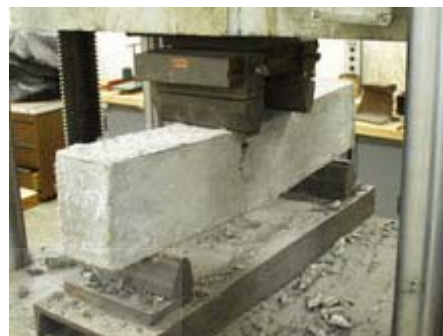
ภาพที่ 3.2 ภาพตัวอย่างการทดสอบกำลังรับแรงดัดของคอนกรีตตามมาตรฐาน ASTM C78-94 (bending Test)
