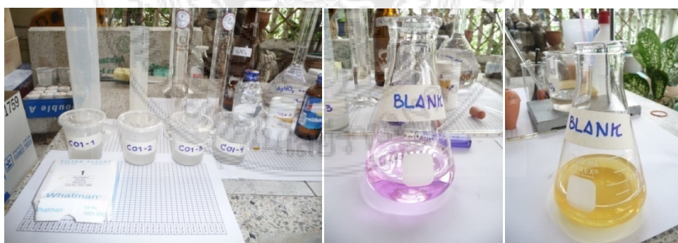
ภาพที่ 3.6 แสดงการเตรียมตัวอย่างในการทดสอบหาปริมาณคลอไรด์, การปรับสภาพความเป็นกรดต่างค่า (pH) และการทำ Blank
