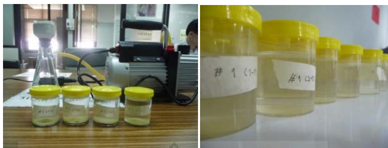
ภาพที่ 3.8 ตัวอย่างการกรองผงคอนกรีตด้วยเครื่องดูดสุญญากาศและการเตรียมตัวอย่างเพื่อทำการไทเทรต (Titration) หาปริมาณคลอไรด์อิสระ
