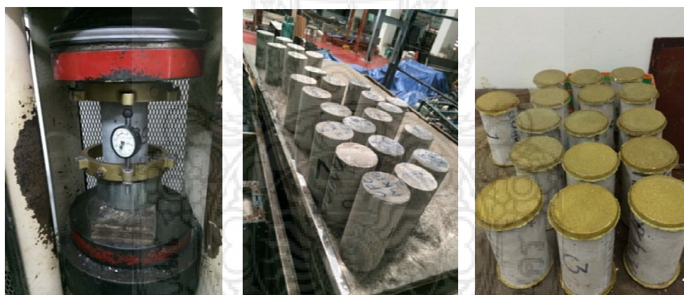
ภาพที่ 3.1 ภาพตัวอย่างการทดสอบกำลังรับแรงอัดตามมาตรฐานของคอนกรีต ASTM C 39
