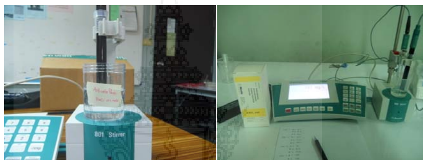
ภาพที่ 3.9 การกระตุ้นการทำงานของ Chloride ISE ด้วยสารละลายคลอไรด์ (NaCl) ความเข้มข้น 0.1 โมล/ลิตร และการหาปริมาณคลอไรด์อิสระด้วยเครื่อง Chloride Analyzer (Metrohm 781 pH/Ion Meter)
