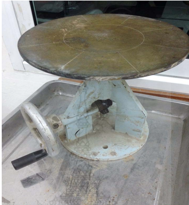
ภาพที่ ข.5 โต๊ะทดสอบการไหลผ่าน (Flow table)
