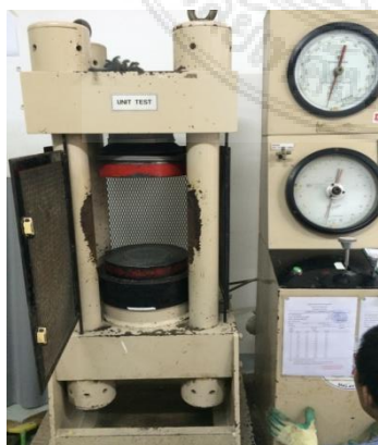
ภาพที่ 3-1 ภาพตัวอย่างการทดสอบกำลังรับแรงอัดตามมาตรฐานของคอนกรีต ASTM C 39
