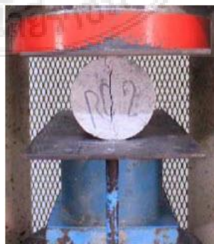
ภาพที่ 3-3 ภาพตัวอย่างการทดสอบกำลังรับแรงดึงของคอนกรีตตามมาตรฐานของ ASTM C 496
