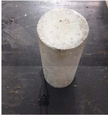
ภาพที่ ค.5 ตัวอย่างคอนกรีตทดสอบแบบทรงกระบอก
