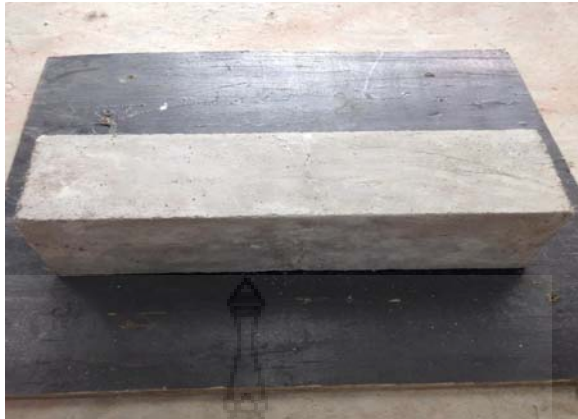
ภาพที่ ค.7 ตัวอย่างคอนกรีตทดสอบแบบคาน
