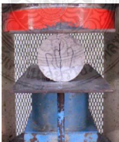
ภาพที่ 2-8 การทดสอบกำลังต้านทานแรงดึงผ่า (Splitting tensile Strength) ASTM C 496
