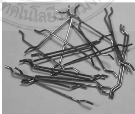
ภาพที่ 2-11 แสดงลักษณะรูปร่างของเส้นใยเหล็กชนิดงอปลาย
