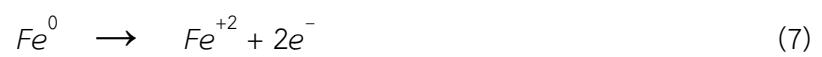
ภาพที่ 2-13 ปฏิกิริยาไฟฟ้าเคมีของการกัดกร่อนบนผิวเหล็กเสริม ที่หมา; วรเดช (2546)
