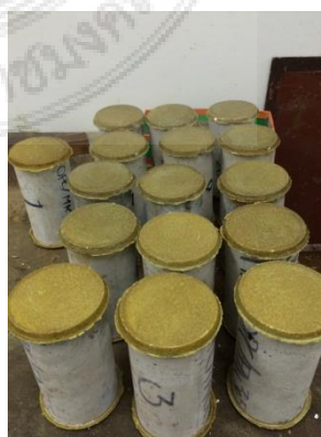
ภาพที่ 3-1 ภาพตัวอย่างการทดสอบกำลังรับแรงอัดตามมาตรฐานของคอนกรีต ASTM C 39
