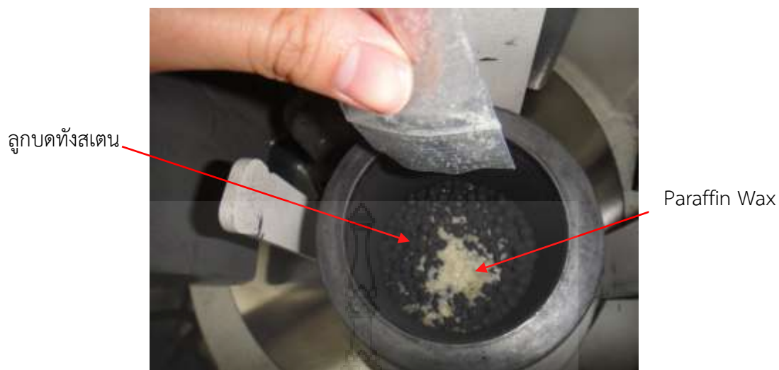
รูปที่ 3.22 เทวัสดุประสานเพื่อการอัดขึ้นรูป (Paraffin Wax) ลงหม้อบด
