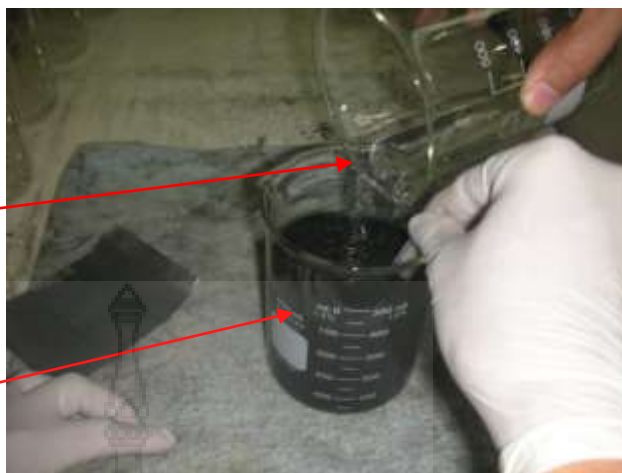
รูปที่ 3.7 ล้างผงทั้งสแตนคาร์ไบด์ด้วยเอทานอล
