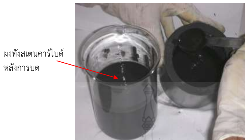
รูปที่ 3.11 แสดงการเตรียมผงทั้งสแตนคาร์ไบด์ระหว่างการบดละเอียด
