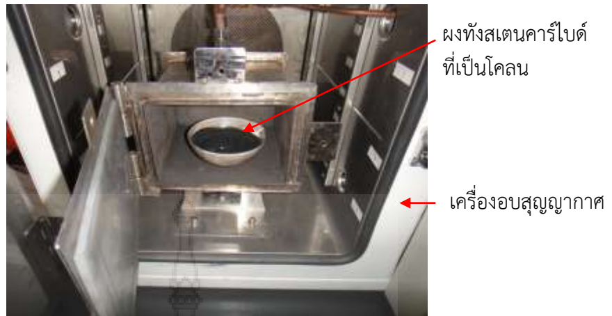
รูปที่ 3.13 แสดงการอบผงโลหะด้วยเตาสุญญากาศ
