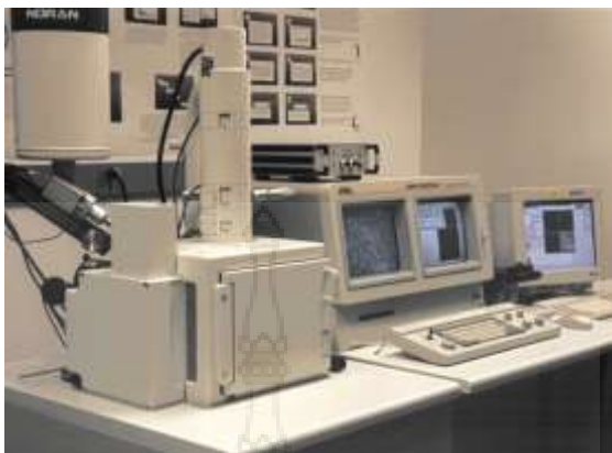
รูปที่ 3.15 แสดงเครื่อง SEM (Scanning Electron Microscope)
