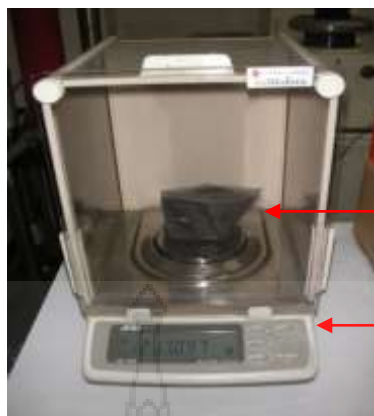
รูปที่ 3.5 ชั่งน้ำหนักผงทั้งสเตนคาร์ไบด์ความละเอียด 1/10,000 กรัม
