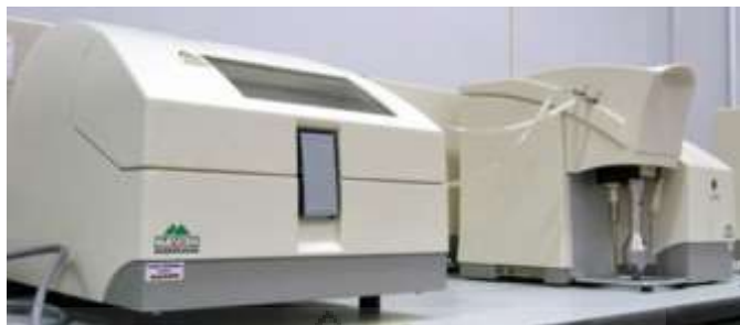
รูปที่ 3.17 แสดงเครื่องวิเคราะห์การกระจายตัวและขนาดอนุภาค (Particle Size Diffraction)
