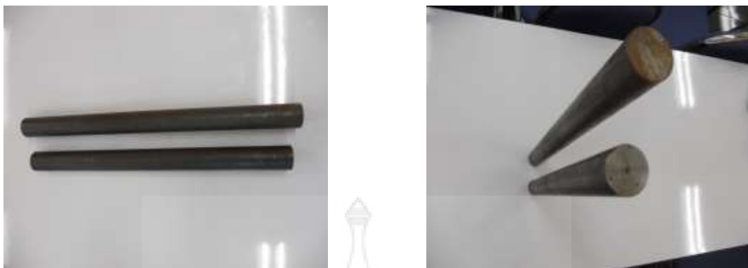
รูปที่ 3.33 เหล็กกล้าคาร์บอนปานกลาง S45C
