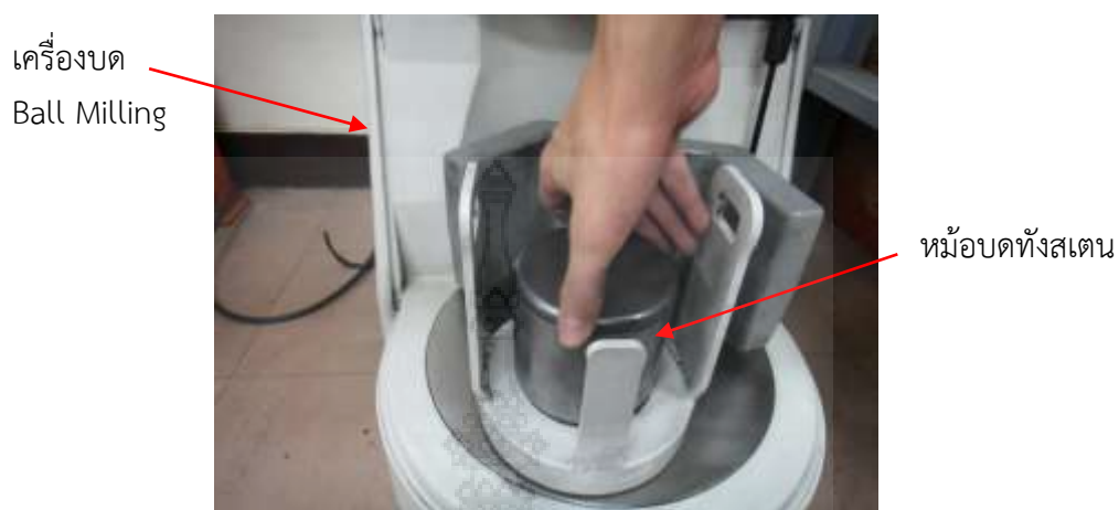
รูปที่ 3.20 การผสมโคบอลต์กับผงทังสเตนคาร์ไบด์ด้วยวิธี Ball Milling
