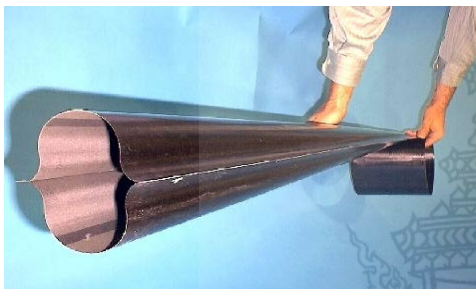
ภาพที่ 14 แสดงแกนCFRP ของใบเรือแสง (Solar sail)
