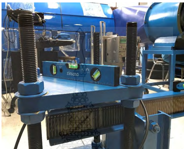
รูปที่ 3.9 การนำระดับน้ำวางลงบนแผ่นปรับระดับโพลดเซลล์
