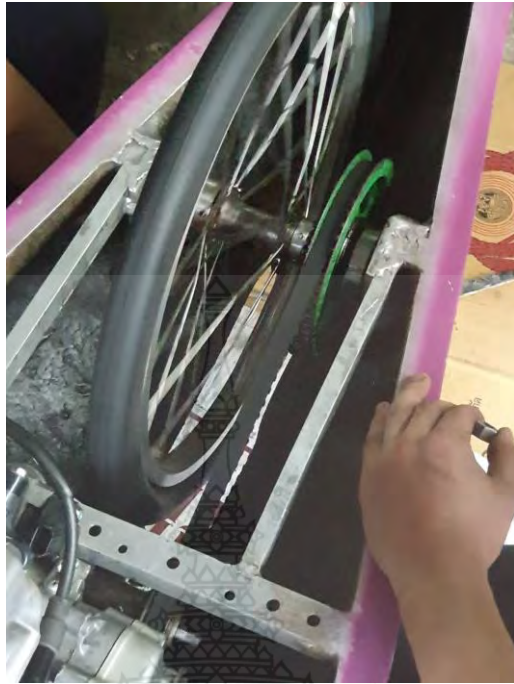
รูปที่ 3.15 การติดตั้งรอกและใส่สายพานและตั้งความตึงของสายพาน
