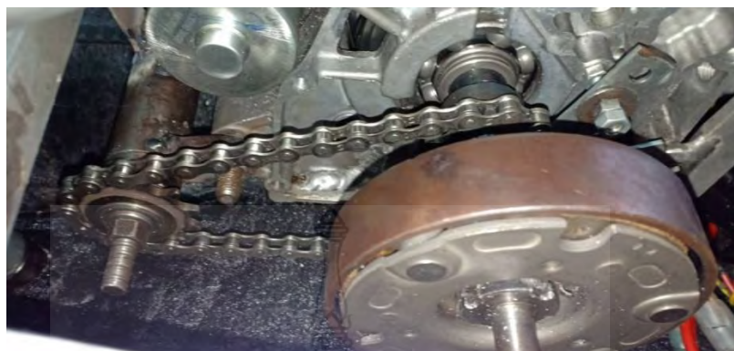
รูปที่ 3.13 การติดตั้งโซ่และตั้งความตึงของโซ่
