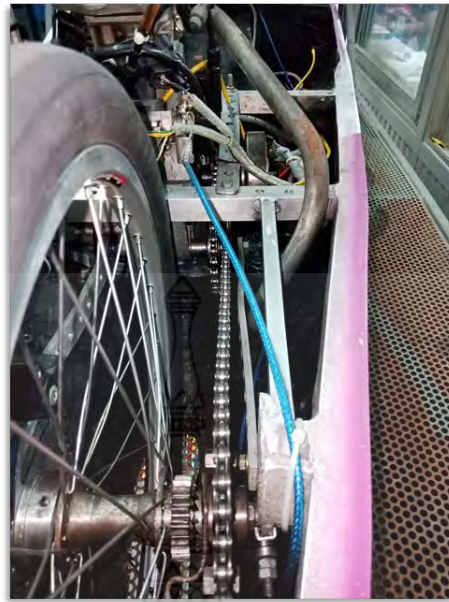
รูปที่ 3.5 ระบบส่งกำลังแบบโซ่และเฟือง
