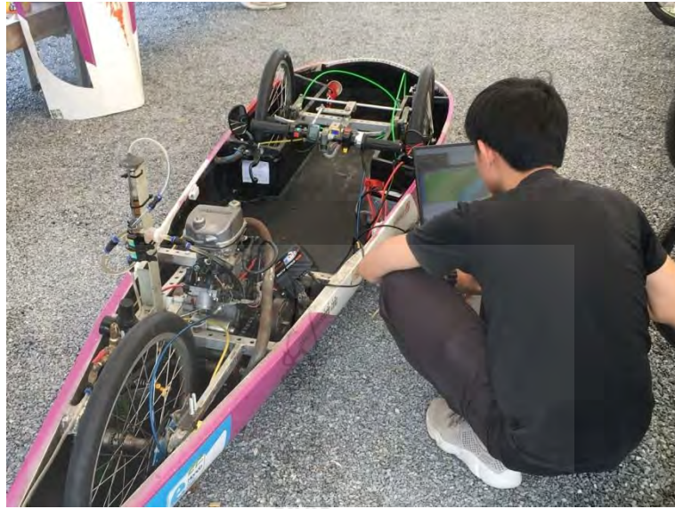
รูปที่ 3.27 การติดตั้งโปรแกรมลงในอุปกรณ์อิเล็กทรอนิกส์ (ECM)
