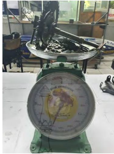
รูปที่ 3.9 ระบบส่งกำลังเดิมมีน้ำหนัก 0.8 กิโลกรัม
