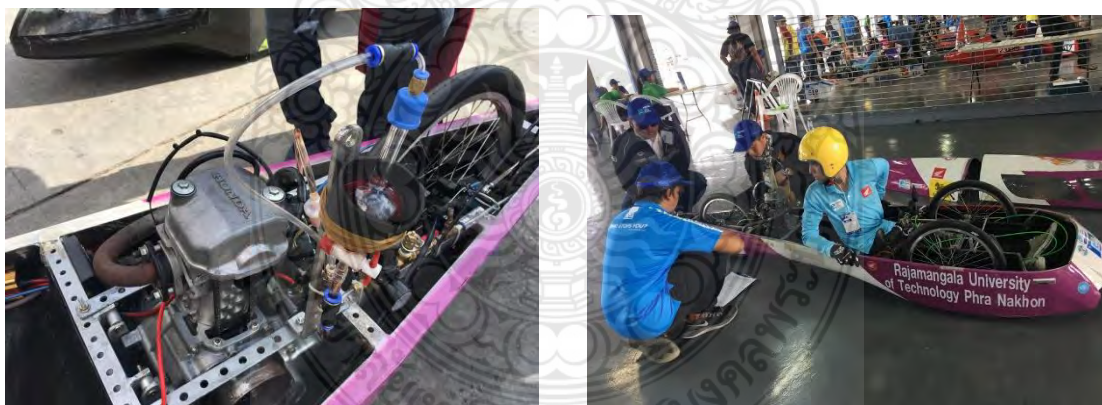
รูปที่ 3.31 การติดตั้งระบบจ่ายน้ำมัน
