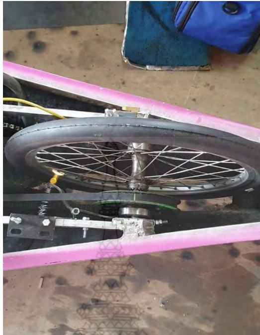
รูปที่ 3.17 การติดตั้งระบบคานและระบบตัดต่อกำลัง
