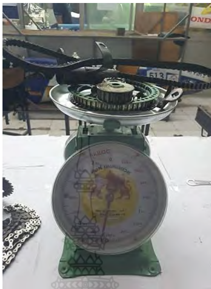
รูปที่ 3.20 ระบบส่งกำลังใหม่ น้ำหนัก 0.7 กิโลกรัม
