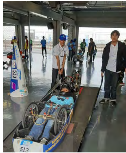
รูปที่ 3.32 การปรับแต่งเครื่องยนต์อีกครั้งก่อนทำการแข่งขัน และการตรวจสอบระบบเบรคพื้นที่ ลาดเอียง
