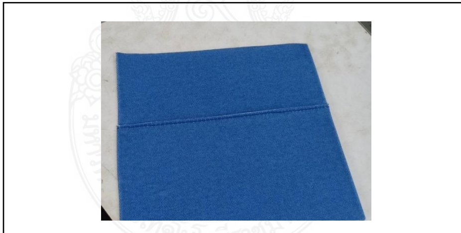
ภาพที่ 3.24 การเย็บตัวกระเป๋าเข้าด้วยกัน
