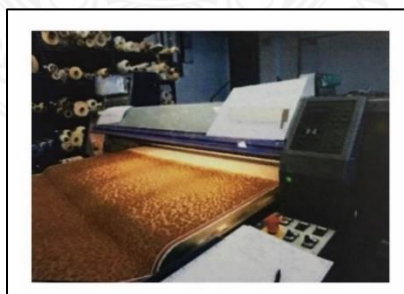
ภาพที่ 2.40 เครื่องพิมพ์ดิจิทัลแบบทรานสเฟอร์
