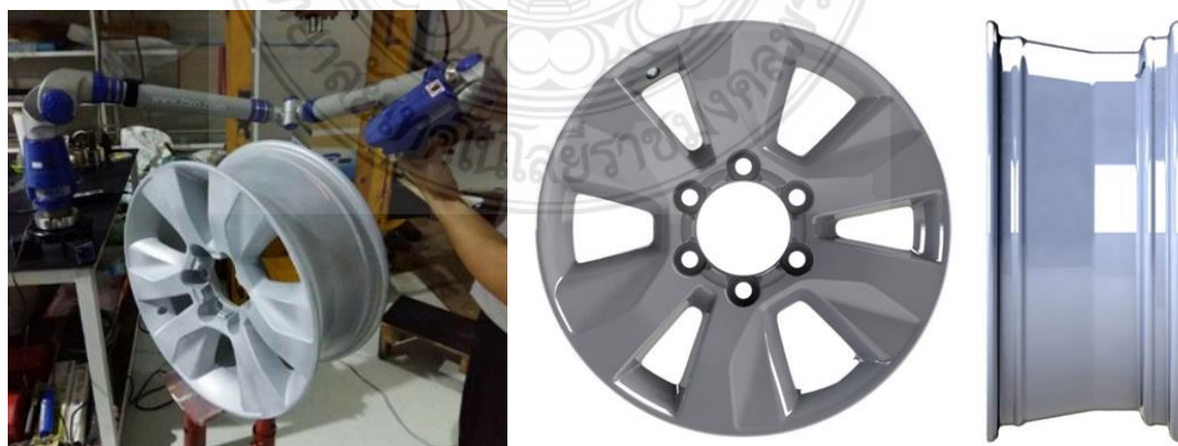
รูปที่ 4.11 สแกนล้ออัลลอยด้วยเครื่อง FARO P06-0513 และโมเดลกระทะล้อ 3 มิติ ที่ได้จากเครื่องสแกนเลเซอร์ FARO
