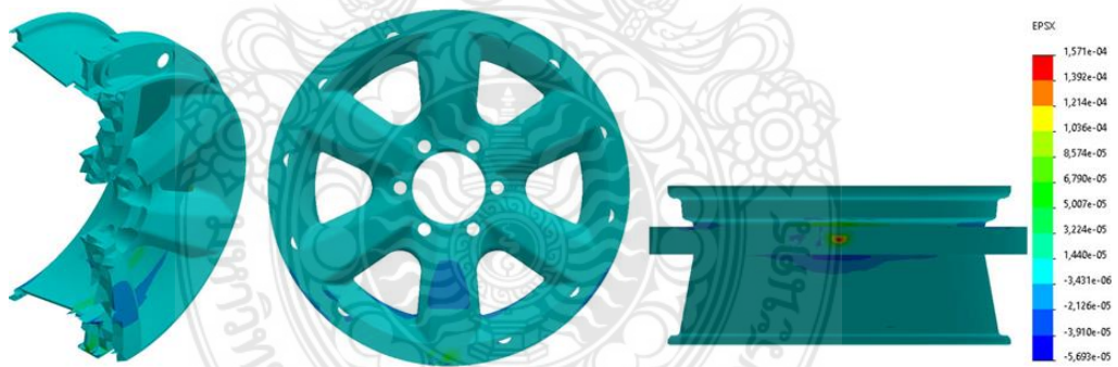
a) ตัวอย่างการเกิดความเครียดในแนวแกน x
