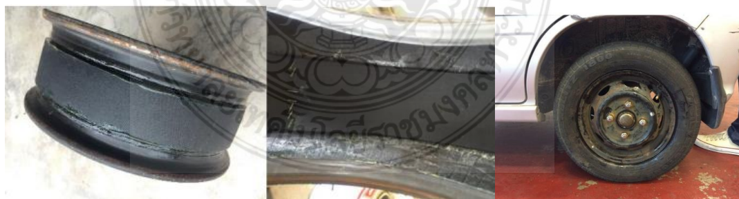
รูปที่ 2.8 ล้อยางลมที่สวมล้อ Run-flat สำหรับการทดสอบ [46]
