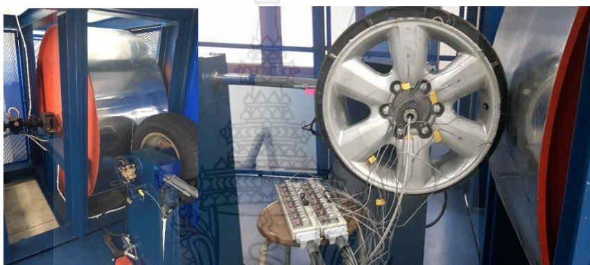
รูปที่ 4.3 การติดตั้งกระทะล้อและล้อรันแพลทเข้ากับอุปกรณ์การทดสอบ
