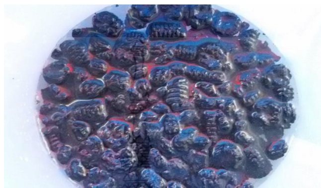
รูปที่ 3.4 การนำถ่านไปแช่น้ำผสมเกลือในอัตราส่วน 1 ลิตรต่อ 7 กรัม
