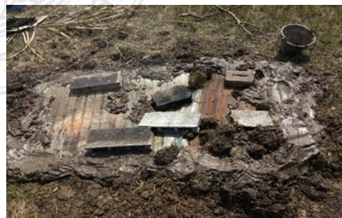
รูปที่ 3.3 เผากะลามะพร้าวโดยเตาแบบเปิดและเตาแบบปิด
