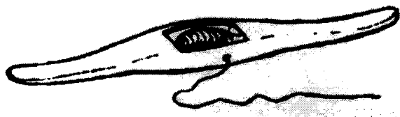
ภาพที่ 8 แสดงกระสวยแบบเรือ 1 หลอด หรือแกนเดี่ยว
