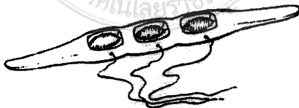
ภาพที่ 10 แสดงกระสวยแบบเรือ 3 หลอด
