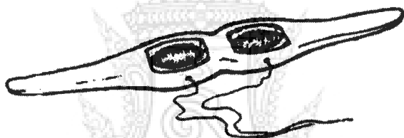
ภาพที่ 9 แสดงกระสวยแบบเรือ 2 หลอด หรือแกนคู่
