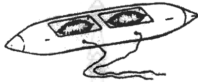
ภาพที่ 11 แสดงกระสวย 2 หลอด แบบพัฒนา
