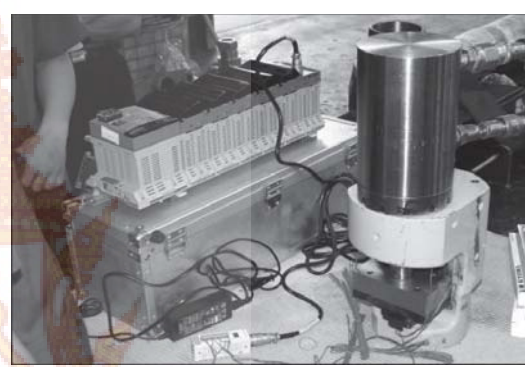
รูปที่ 6 ติดตั้ง DAQ Master, Gage selects เข้ากับ Strain gauges
