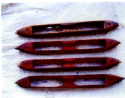
ภาพที่ 2.11 แสดงกระสวยสำหรับสอยด้ายพุ่ง
