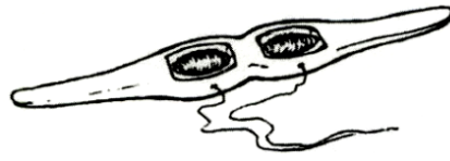
ภาพที่ 2.19 แสดงกระสวยแบบเรือ 2 หลอด หรือแกนคู่
