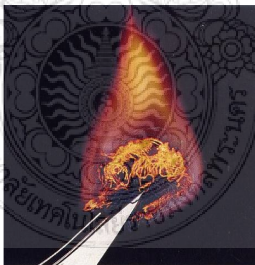
รูปที่ 2.20 การเผาเส้นใยฝ้าย ลินิน และเรยอน
